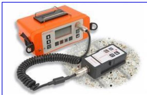
Lo strumento è inoltre dotato di tasti di controllo, di un indicatore digitale ausiliario per la misura della forza del segnale e di un avvisatore acustico, assai utile per la determinazione preliminare della posizione dei ferri d'armatura.
