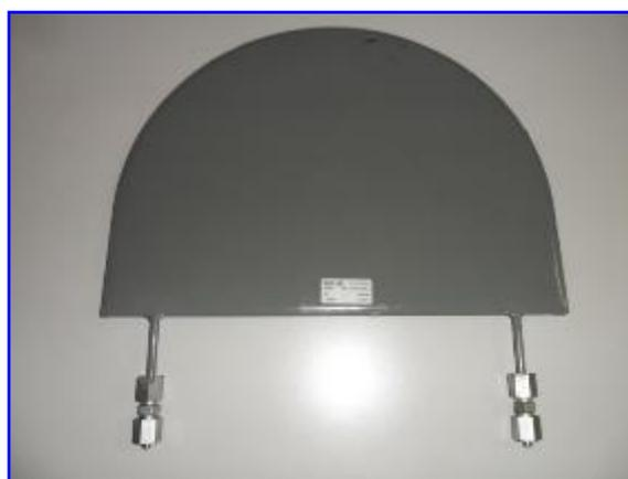
Mediante il coefficiente "Km" fornito dal costruttore si determina la riduzione della sezione di spinta del martinetto, tenuto conto dell'influenza della maggiore rigidità del bordo e dello stato di affaticamento e deformazione dello strumento.
