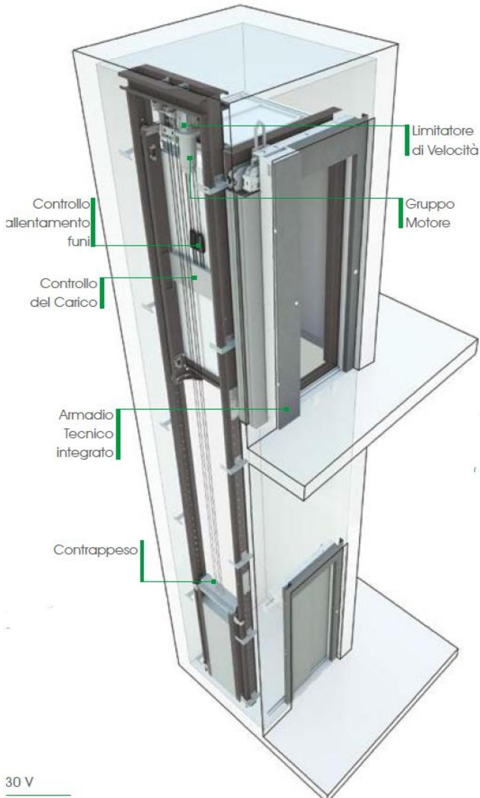
Ascensore - Fornitura ed installazione di nuovo ascensore automatico MRL (Machine Room Less) in vano corsa in struttura metallica esterna e tamponamento in cristallo stratificato.
