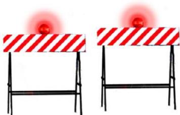
Le barriere di testata delle zone di lavoro devono essere munite di idonei apparati luminosi di colore rosso a luce fissa (almeno una lampada ogni 1,5 m di barriera di testata)
