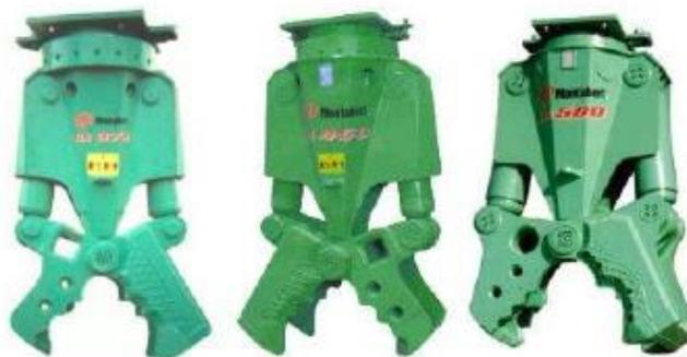
Le Pinze Demolitrici, montate sugli escavatori, dispongono nei pressi della cerniera – dove la pressione è maggiore – di “Coltelli” per tagliare la muratura legata o i passaggi delle tubazioni contemporaneamente all'azione frantumatrice dei denti. Questo al fine di evitare la presenza di personale che effettui manualmente questa operazione, per sezionare la muratura che, altrimenti, continuerebbe a collegare fra loro i blocchi separati in fase di demolizione.
